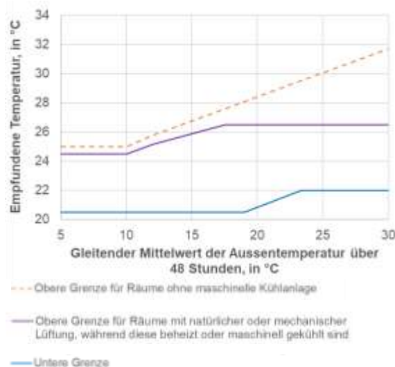
Abbildung 41: Zulässiger Bereich der empfundenen Temperatur in Räumen mit natürlicher oder mechanischer Lüftung, während diese beheizt oder maschinell gekühlt sind (Bereich zwischen der blauen und der violetten Linie) oder in Räumen ohne maschinelle Kühlanlage (Bereich zwischen der blauen und rot gestrichelten Linie), in Abhängigkeit des Mittelwerts der Aussentemperatur (angelehnt an die SIA 180:2014 (52)).
