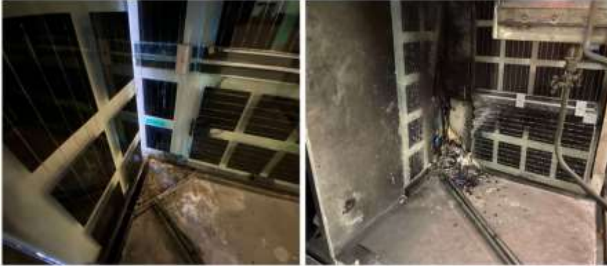
Abbildung 25: Brandversuch von PV-Elementen, horizontal angebracht (Quelle: Pierre-Olivier Cuche).
