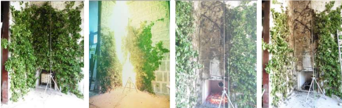
Abbildung 19: Fotodokumentation eines Brandversuchs mit Efeu. Bilder von links nach rechts: Prüfstand vor der Brandprüfung (Bild 1); kurzzeitige vertikale Brandweiterleitung während der Prüfphase (Bild 2); Fassadenbegrünung zum Ende der Brandprüfung (Bild 3); Fassadenbegrünung nach der Brandprüfung – keine seitliche Brandweiterleitung erkennbar (Bild 4) (Quelle: Stadt Wien).
