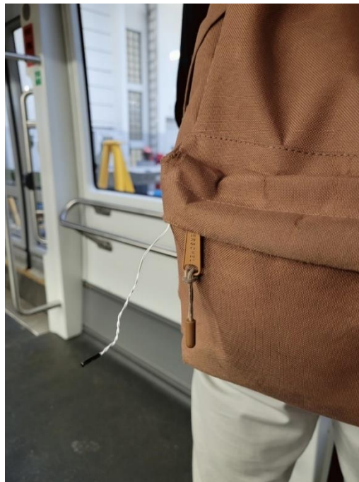
Abbildung 5: Messspitze eines Temperaturloggers zur Messung der Raumlufttemperatur durch die Befragenden in einem Fahrzeug während der Fahrgastbefragung.
