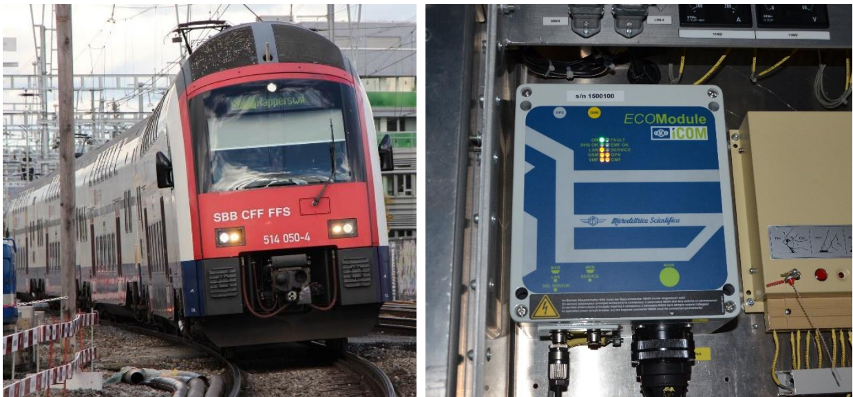
Abbildung 16: DTZ-Triebzug der Zürcher S-Bahn (RABe 514) Links: Aussenansicht, rechts Energiemessgerät zur Verrechnung des Bahnstroms (Quelle: SBB).
