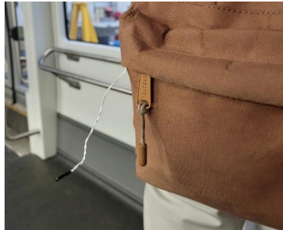
Parallel wurden die Fahrgastraumtemperaturen mit einem Datenlogger aufgezeichnet.
