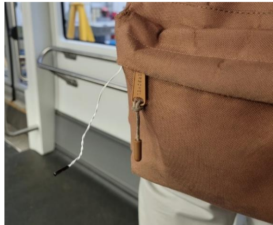
En parallèle, la température des compartiments voyageurs était mesurée à l'aide d'un enregistreur de données.
