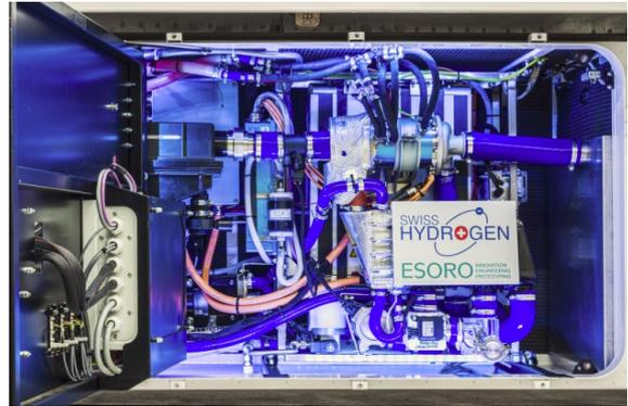
Abbildung 26: Brennstoffzellensystem (Bildquelle: [www.coop.ch](http://www.coop.ch))
