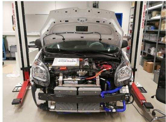
Abbildung 28: Eingebautes Brennstoffzellensystem
