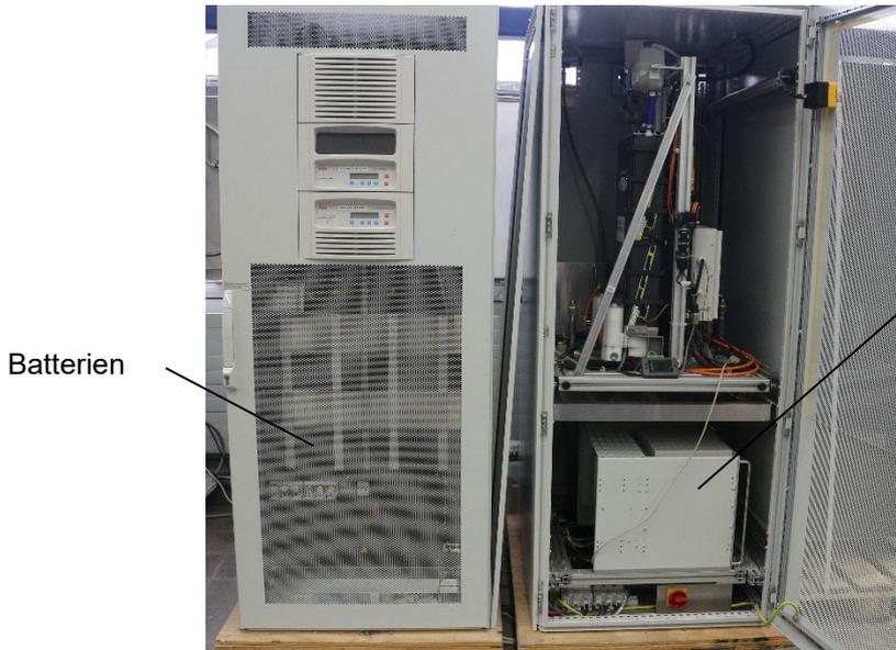
Abbildung 7: Rack 2 der Systemarchitektur 2 mit Brennstoffzellensystem und DC-DC Wandlern
