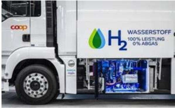
Abbildung 25: COOP Lastwagen mit eingebautem Brennstoffzellensystem (Bildquelle: [www.coop.ch](http://www.coop.ch))
