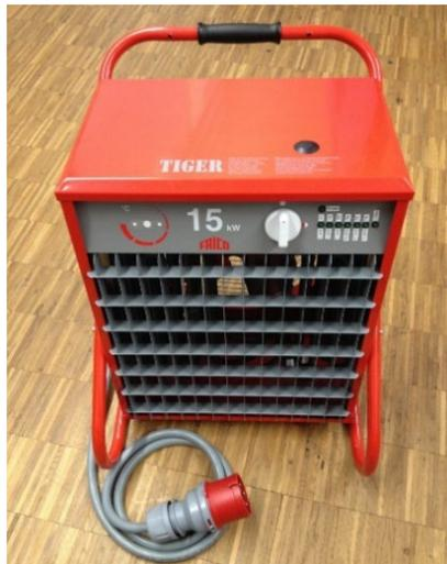
Abbildung 12: Modifizierter Heizlüfter als 'elektronische' Last
