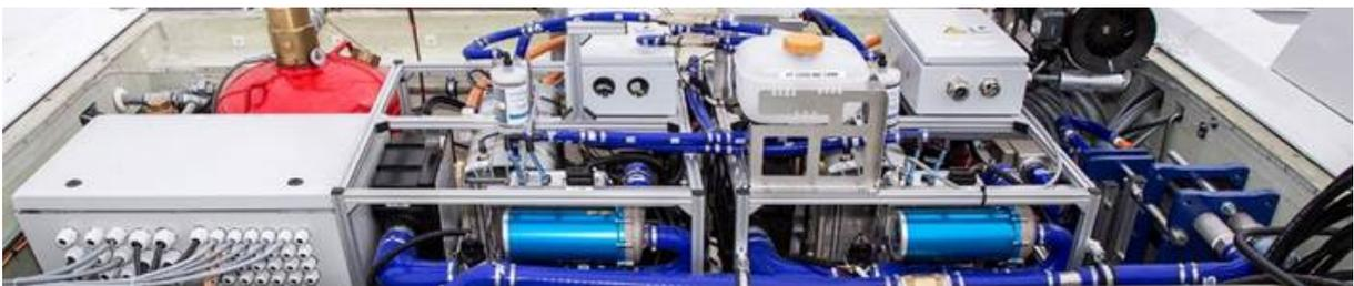
Abbildung 24: Eingebautes Brennstoffzellsystem im Solarboot
