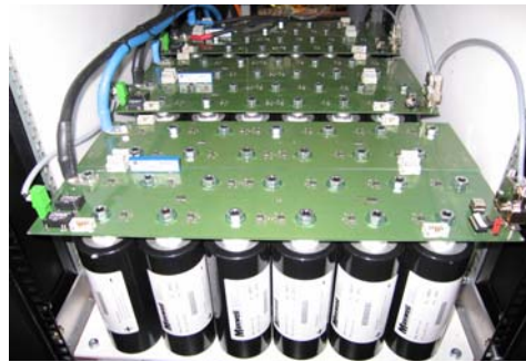
Abbildung 7: Teilmodule der Superkapazitäten eingebaut im Rack
