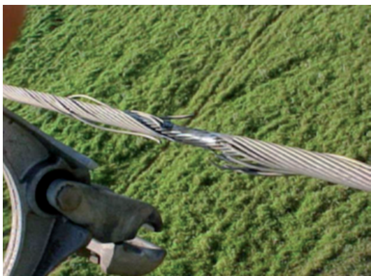
Abbildung 2: Geschädigte Klemmstelle
