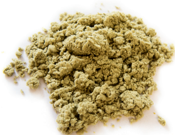
Die Dämmelemente TexLining sind mit granulöser Steinwolle gefüllt.
