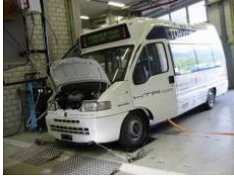
Abbildung 21 TR auf dem Rollprüfstand
