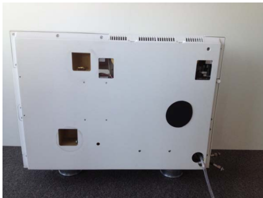
Abb. 5: Unzugängliche Rückseite Prototyp P019 als Befestigungselement für Komponenten
