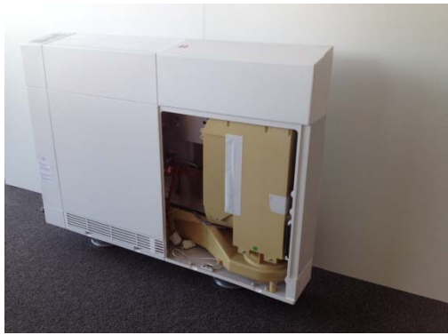
Abb. 3: Front Prototyp P019 ohne Abdeckung Elektrofilter Aussenluft mit Wärmetauscher
