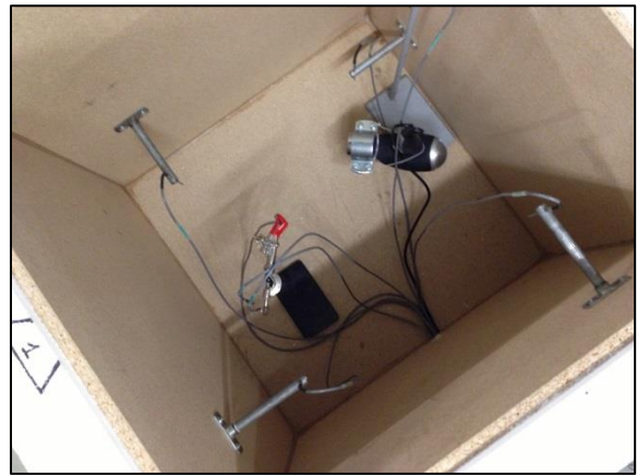
Abbildung 55: Fühlerplatzierung und Wärmequellenposition (Föhn)
