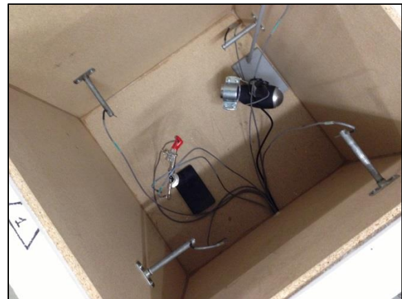
Abbildung 12: Fühlerplatzierung und Wärmequellenposition (Föhn)
