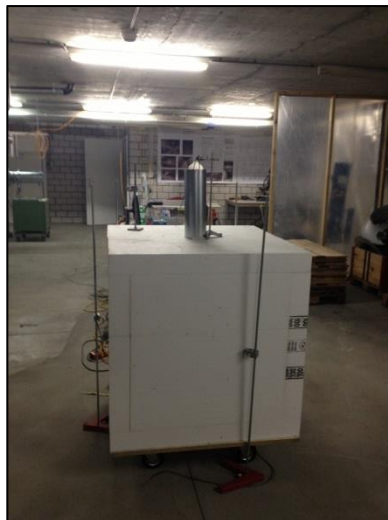
Abbildung 56: Ansicht Prüfbox mit eingebauter Funktionsöffnung
